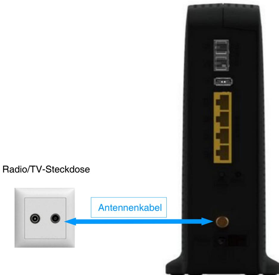
Sollte das Modem nach einer Stunde nicht online sein (siehe Seite 5), schrauben Sie den Radiostecker vom Antennenkabel weg und schliessen Sie den Optimizer an der Dose an und verbinden Sie das Antennenkabel mit dem „Data in/out“-Anschluss vom Optimizer. Den Radiostecker den Sie vom Antennenkabel weg geschraubt haben oder den Optimizer (je nach dem was Sie nicht benötigen) können Sie bei Gelegenheit bei uns zurück bringen. Vielen Dank.
